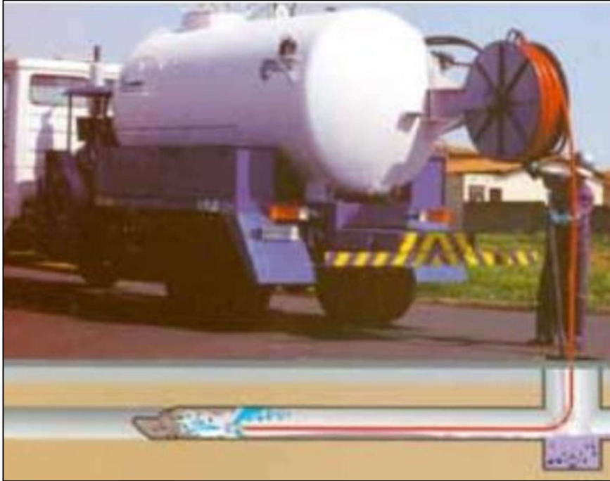
Figura 33: Desobstrução de rede com Sewer Jet. Fonte: Araricá Saneamento.
