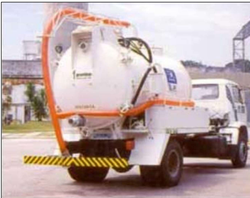
Figura 34: Desobstrução de rede com Vácuo Flex. Fonte: Araricá Saneamento.
