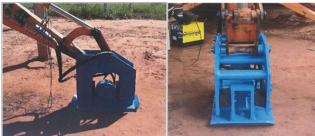
**Figura 6 - Vistas lateral e frontal compactador/estaqueador acoplado a retroescavadeira**
